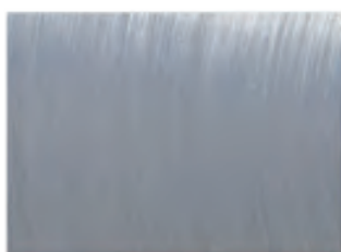
N6 R a 0,8 µm – AARH / CLA 32 R z 3,20 µm
