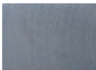
N5 R a 0,4 µm – AARH / CLA 16 R z 1,92 µm
