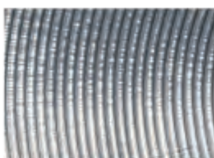
N10 R a 12,5 µm – AARH / CLA 500 R z 48,7 µm
